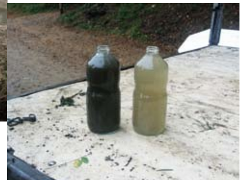
Lors d'une vidange, de l'eau prise dans la pêcherie et de l'eau prise en sortie de bassin de décantation
